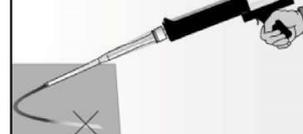
Einen etwa 10 cm langen Strang auspressen, bis der Mörtel gleichmäßig grau gefärbt ist.<br>Nicht gleichmäßig grauer Mörtel ist zu verwerfen. |
