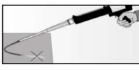
Einen etwa 10 cm langen Strang auspressen, bis der Mörtel gleichmäßig grau gefärbt ist. Nicht gleichmäßig grauer Mörtel ist zu verwerfen |
