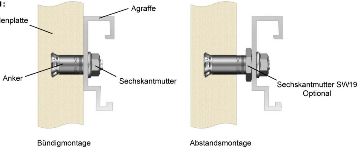
**Beispiel einer Fassadenplatte auf einer Unterkonstruktion**
